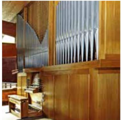
haben insgesamt 1.780 Pfeifen aus Zinnbleilegierungen von 75 % und 40 % für die Metallpfeifen und Holzpfeifen aus Mahagoni- und Eichenholz. Zur Bauweise: mechanisches Schleifladenwerk in traditioneller handwerklicher Bauweise mit teilweise moderner Technologie. Die Windladen wurden aus Mahagoniholz gefertigt, die mechanischen Wellaturen der Spieltrakturen aus Leichtmetall und mittels Holzabstrakten aus Fichtenholz über Holz-
