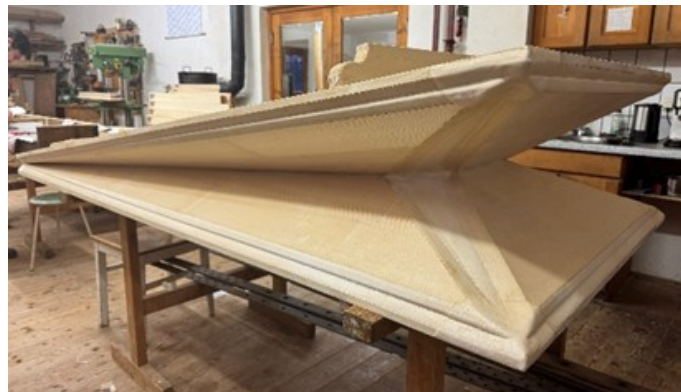
Abbildung 1 Der neue Blasbalg besitzt die Form eines Keiles
