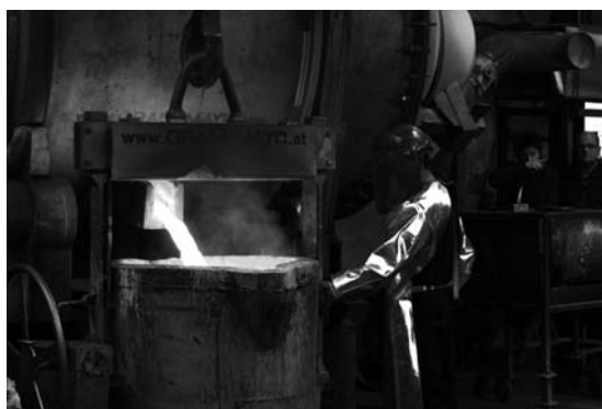
Foto oben: Flüssige Bronze wird mit einem Erlenstamm gerührt Foto: M.Greil-Payrhuber
