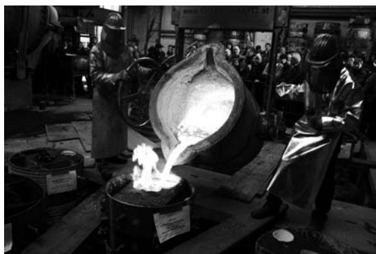
Foto unten: Bronze wird in die Lichtenberger Glockenform gegossen Foto: E.Greil
